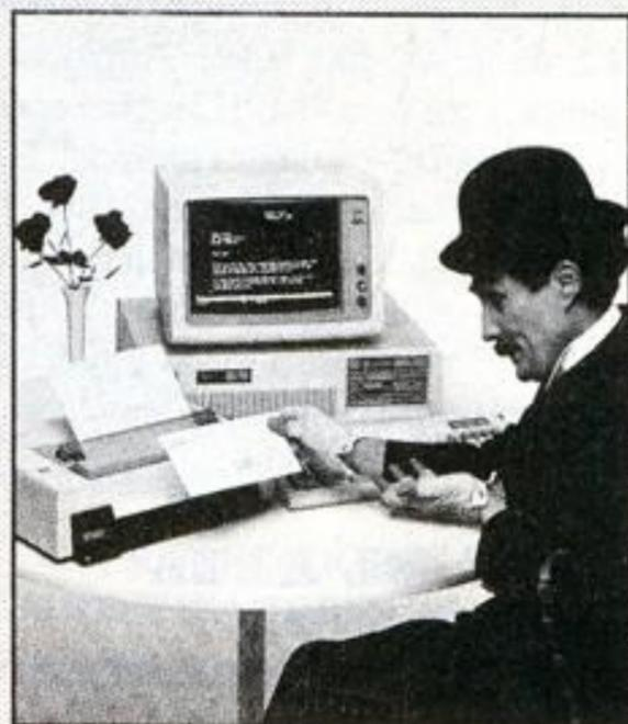
**L**a IBM Proprinter es compatible con toda la línea de computadoras personales IBM, también puede ser conectada a aquellas que posean interfase compatible. Además, existe una interfase en serie que permite conectar esta impresora a cualquier computadora hogareña.
